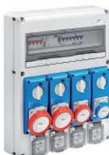
Sistema completo di quadri elettrici IP65 per la distribuzione di energia in ambito terziario, industriale e cantiere, disponibili nella versione sia vuota che cablata, secondo la norma internazionale IEC 61439. La gamma Q-DIN è composta da quadri da 5 a 20 moduli DIN e dai moduli supplementari da 14 e 20M per avere maggiori spazi DIN. Consentono l'alloggiamento di prese da incasso ed interbloccate fino a 63A, e sono ampiamente accessibili.
