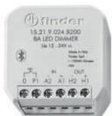
Dimmer PWM YESLY da incasso comandabile da smartphone per strisce LED da 12 a 24 V DC. Corrente massima: 8 A. Il dispositivo è associabile a pulsanti wireless e GATEWAY2 per un controllo smart.
