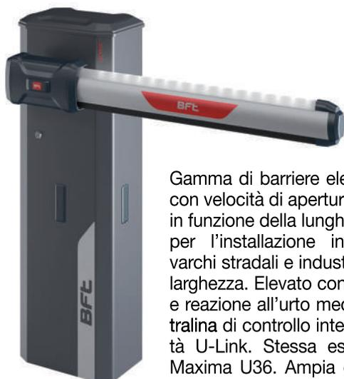
Gamma di barriere elettromeccaniche 24V con velocità di apertura da 2,2 a 4 secondi, in funzione della lunghezza dell'asta. Ideale per l'installazione in grandi parcheggi, varchi stradali e industriali da 2 a 6 metri di larghezza. Elevato controllo del movimento e reazione all'urto mediante encoder. Centralina di controllo integrata con connettività U-Link. Stessa estetica della barriera Maxima U36. Ampia gamma di accessori per ogni tipo di applicazione.
